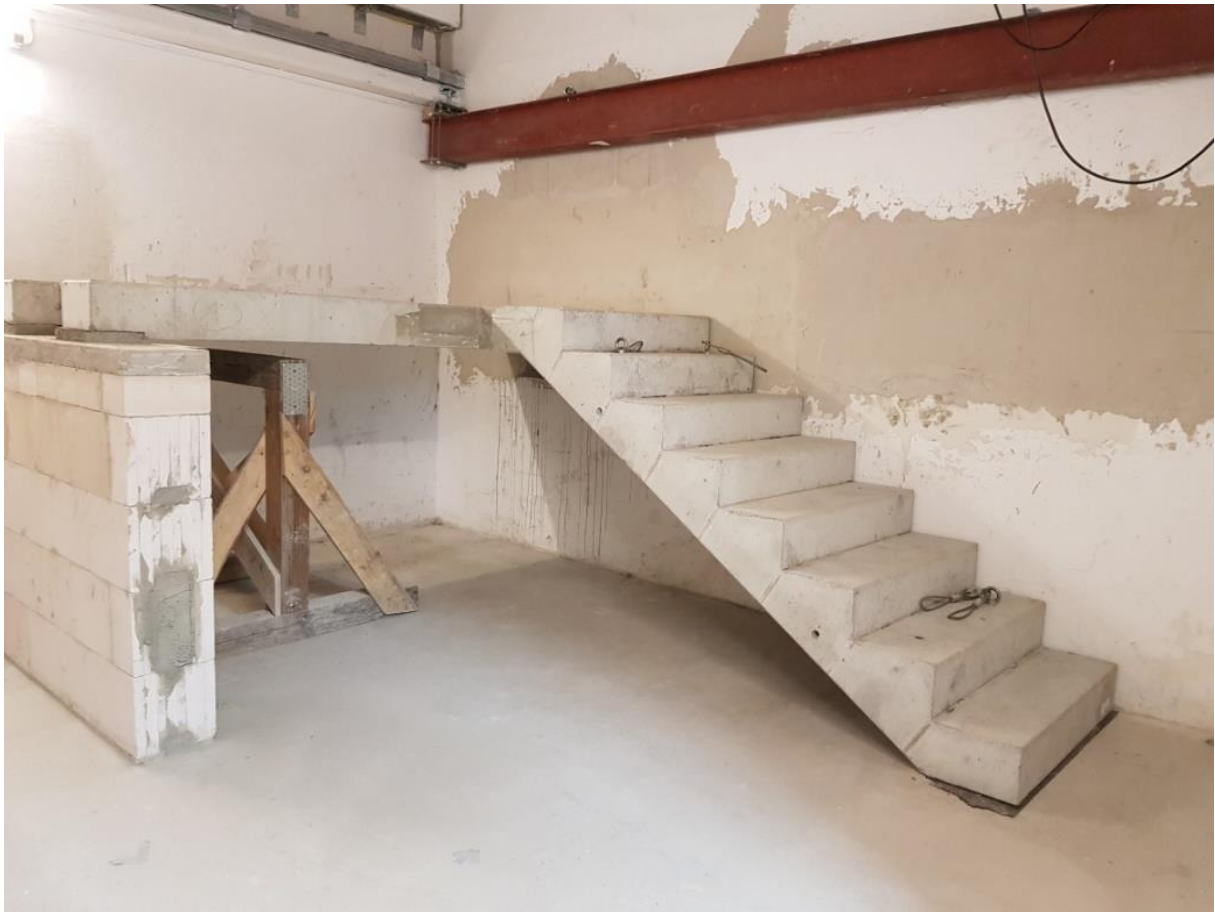
Abbildung 9: Referenztreppenlauf starr an das Referenztreppenpodest angebunden
