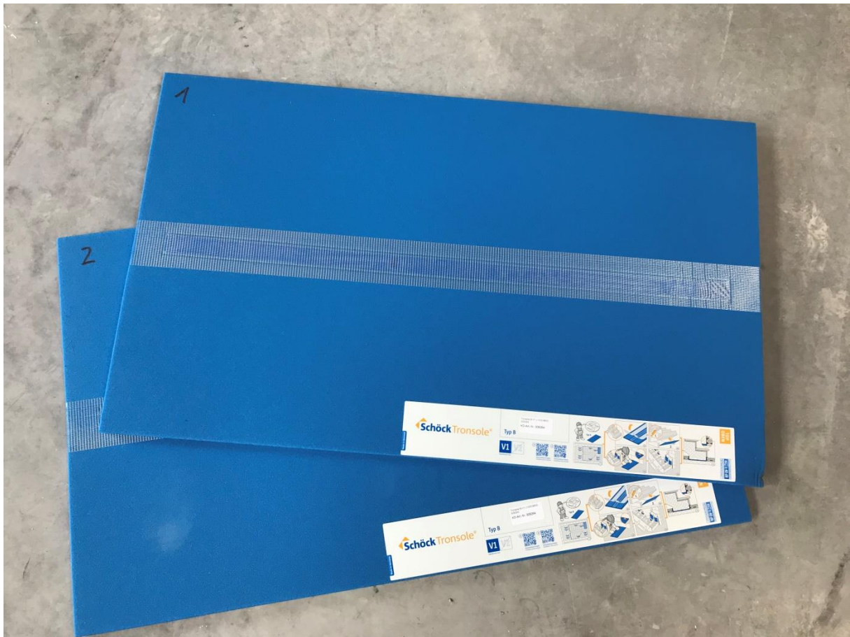
Abbildung 5: Geprüfte Schöck Tronsole® Typ B-V2-L1000 (oben), in drei Teile aufgeteilt aufgrund der Auflagerung auf der Podestkonsole, und Typ B-V1-L1000 (unten) – Zustand vor der Zerschneidung in drei Teile
