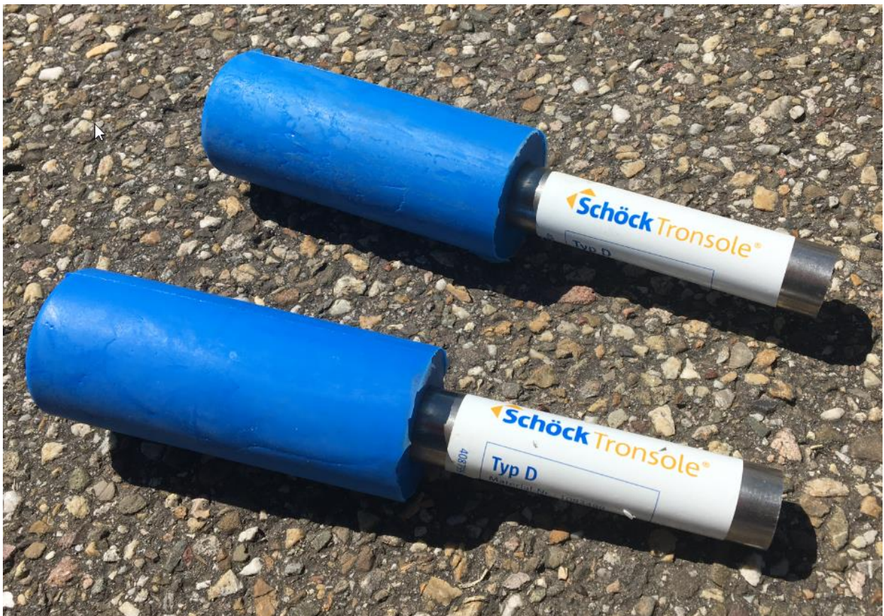
Abbildung 6: Geprüfte Dorne Schöck Tronsole® Typ D
