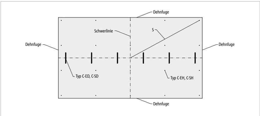
Abb. 29: Schöck Isolink®: Abstand  $S$  zwischen dem Verformungsruehpunkt und dem äußersten Isolink® Typ C-EH, C-SH
